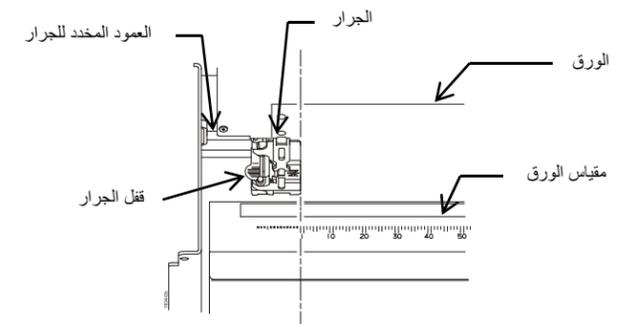
تنبيه: تجنب تسحب لوح الطباعة عن طريق وضع الجرار الأيسر إلى يسار العلامة "1" على مقياس الورق.
