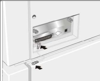
**Si l'imprimante est installée sur une table, ce n'est pas nécessaire de brancher le câble de terre.**
